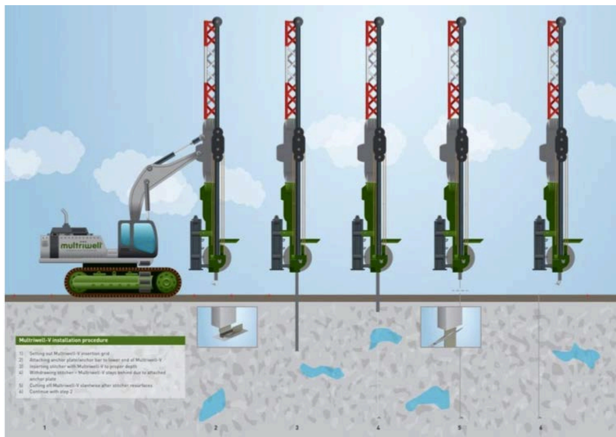
Рисунок 3-4 Изображение установки вертикальных частей системы Multriwell
