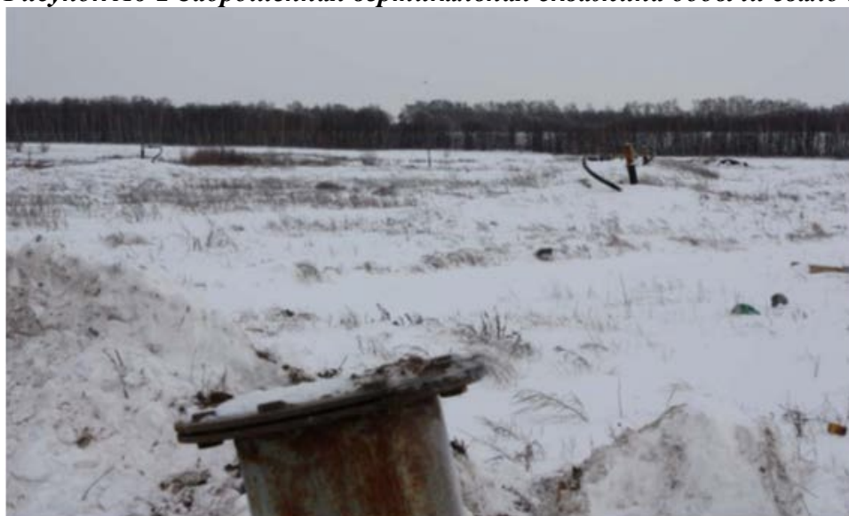
Рисунок А6-2 Заброшенная вертикальная скважина добычи свалочного газа
