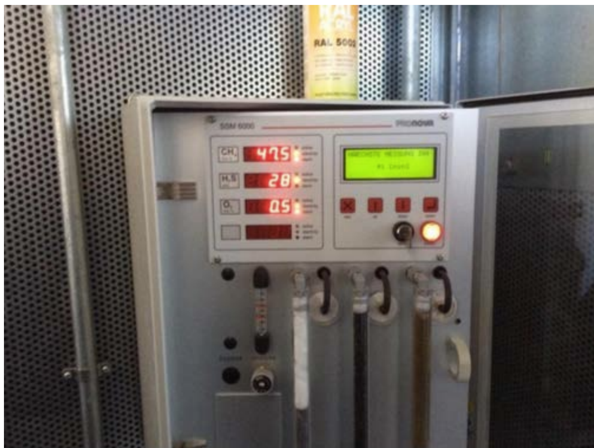
Рисунок А6-4 Интерактивное измерение добытого свалочного газа с полигона в Самаре
